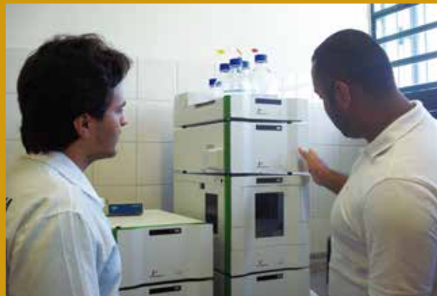
Cromatógrafo é instalado em laboratório da Fatec Araçatuba
